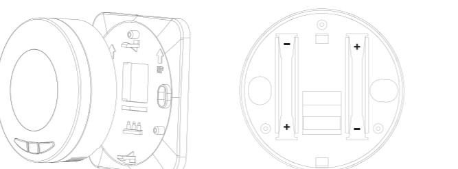
Вставьте 2 щелочные батарейки типа AAA (типа LR03) из коробки принадлежностей в гнезда, соблюдая указанную полярность.
