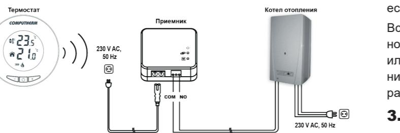
Радиус действия передатчика сигнала в открытой местности составляет приблизительно 100 м. Это расстояние значительно сократится внутри здания при наличии металлических или железобетонных конструкций, а также при глиняных стенах, которые мешают прохождению радиоволн.
