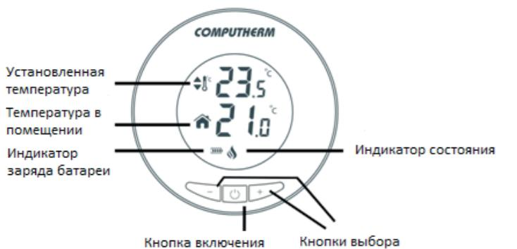
Устройство состоит из двух блоков. Один - переносной блок управления (термостат), другой - приемный блок, управляющий котлом. Между двумя блоками существует беспроводная (радиочастотная) связь, поэтому нет необходимости прокладывать провод между термостатом и котлом.
